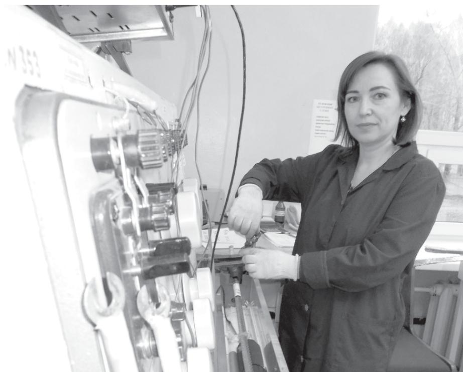
**Измерения электрического сопротивления токопроводящей жилы и замер удельного сопротивления проволоки на микроомметре проводит инженер О.В. Макарова. «Точность измерений зависит и от оборудования, и от человеческого фактора», — уверена Ольга Васильевна**
