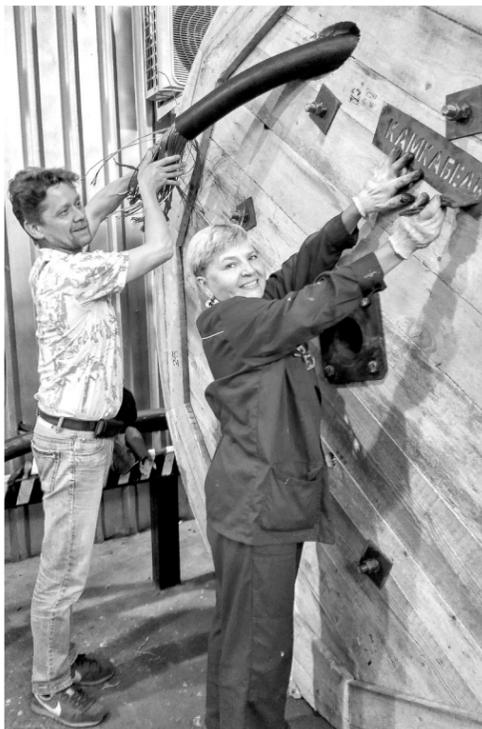
**Маркировку на шахтный кабель перед отправкой потребителю наносит монтер участка сдачи готовой продукции Е.А. Анохина. Слева – монтер кабельного производства ОТК А.С. Трушников**
