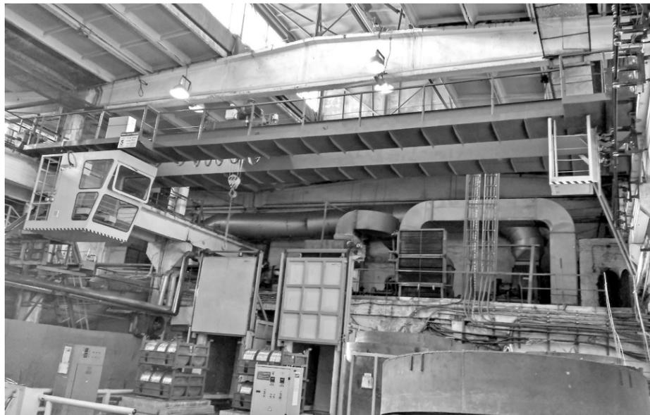
– По просьбе цеха на новом кране установлена закрытая застекленная кабина, оборудованная кондиционером и печью. Кран оснащен частотным управлением, скоростями механизмов управляет встроенный компьютер, благодаря чему обеспечивается плавность работы механизмов, значительно увеличивается их ресурс и экономится электроэнергия.
