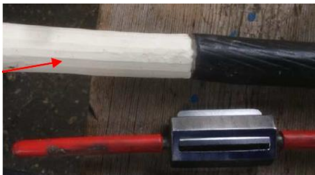
Рисунок 5 – Удаление электропроводящего экрана по изоляции на кабелях с изоляцией из невысокомодульной этиленпропиленовой резины.
