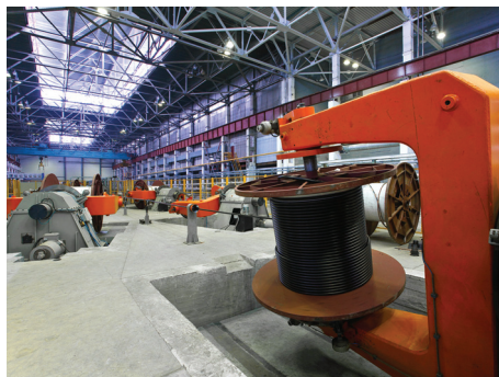
Линия общей скрутки и экранирования
