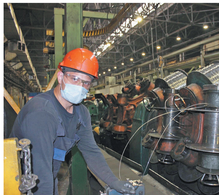
Скрутчик А.А. Федоров изготавливает из алюминиевого сплава жилу для СИП
