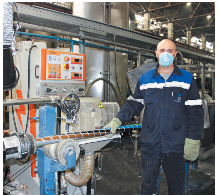
ooo Опрессовщик кабелей и проводов пластикатами и резиной УКПИ А.В. Мухин изготавливает кабель крупного сечения в HF-изоляции
