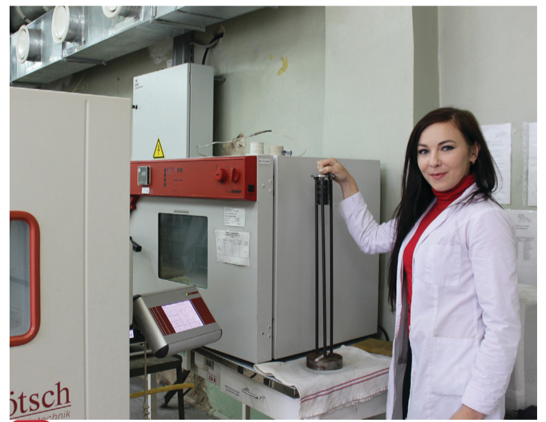
Проверку изоляции на хрупкость выполняет О.А. Кухарева
