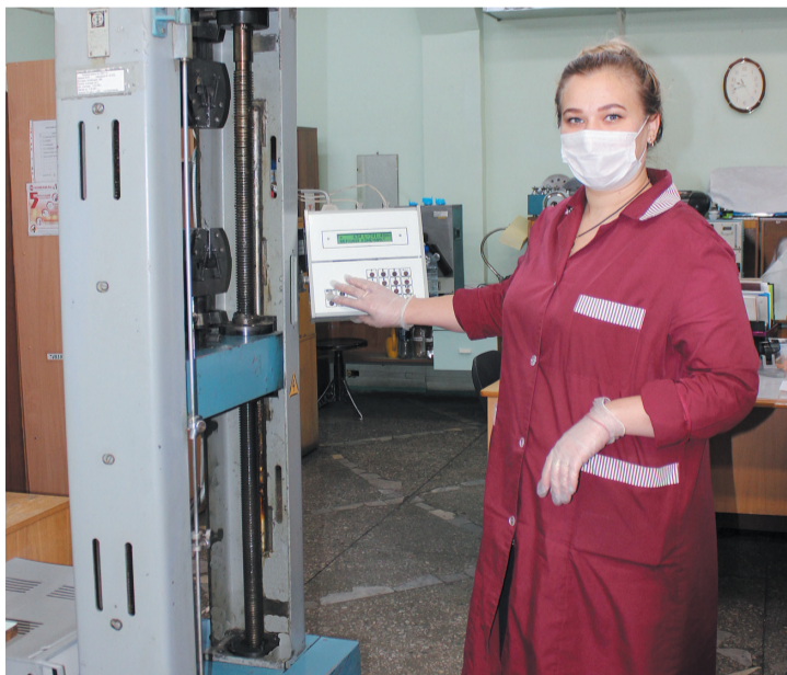
К.Н. Хомякова испытывает провод на повреждения изоляции
