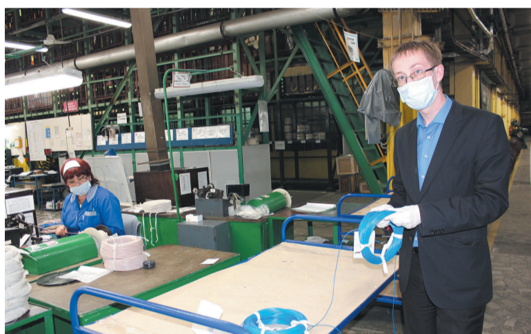
Начальник КТБ МП С.И. Кулаков проверяет качество перемотанного перед испытаниями провода МГШВ
