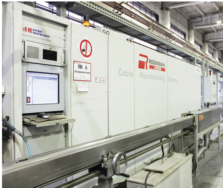
Изолирование кабелей управления выполняется на экструзионной линии RN A Rosendahl
