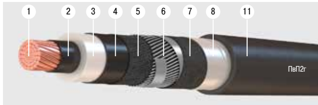
Рисунок 1. Силовой одножильный кабель с изоляцией из сшитого полиэтилена с проволочным экраном из алюминий-циркониевого сплава в полиэтиленовой оболочке
