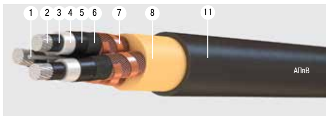
Рисунок 7. Силовой трехжильный кабель с изоляцией из сшитого полиэтилена в оболочке из поливинилхлоридного пластика, не распространяющий горение при одиночной прокладке
