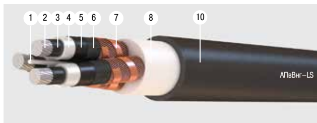
Рисунок 11. Силовой трехжильный кабель с изоляцией из сшитого полиэтилена в оболочке из поливинилхлоридного пластика, не распространяющий горение при прокладке в пучках
